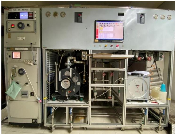
图 3-1 燃气采暖热水炉、燃气快速热水器检测系统
