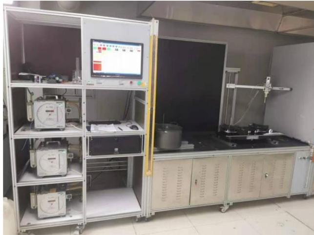
图 3-2 燃气灶检测系统
