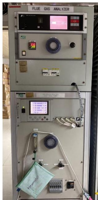
图 3-3 富士 GASRACK-Z 型烟气分析仪
